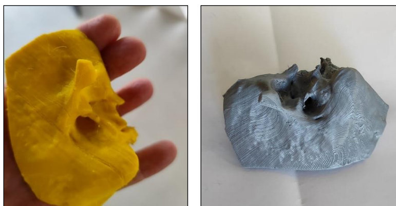
Figura 2: Peça da esquerda impressa em temperatura igual a 200°. Amostra da direita impressa em temperatura próxima a 210° (observam-se ondulações em excesso, denunciando escoamento da camada).
