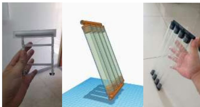
Figura 5. Impressão 3D reator laminar/Projeto 3D do reator tubular/Impressão 3D reator laminar
