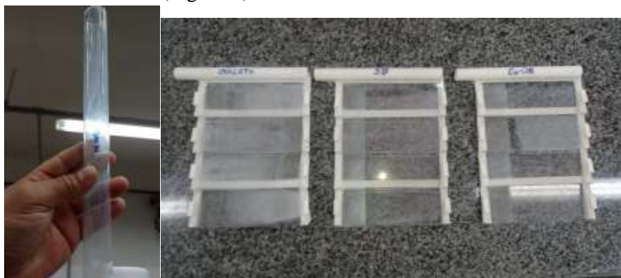
Figura 4.. Filme sol-gel homogêneo depositado no substrato tubular e laminar.
