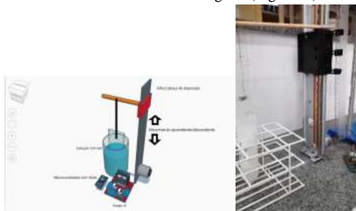
Figura 2. . Projeto/Foto do equipamento de dip-coating para deposição em lâminas de vidro
