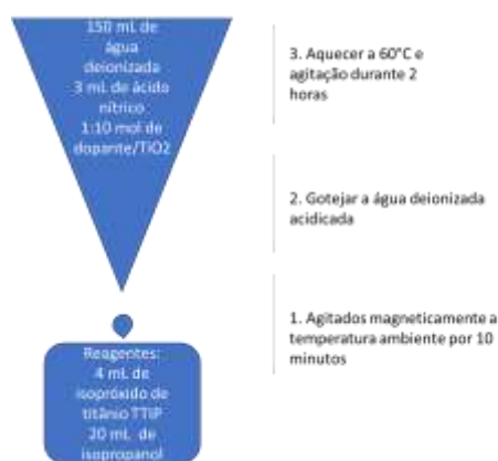
Figura 1. Síntese do filme de \text{TiO}_2 dopado pelo método sol gel. Fonte:Autor
