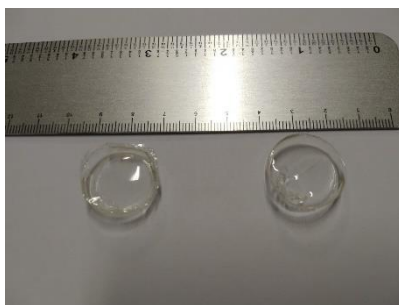
Figura 5: a esquerda: compósito polimérico de PVC com nanogipsita e a direita filme de PVC usado como controle.
