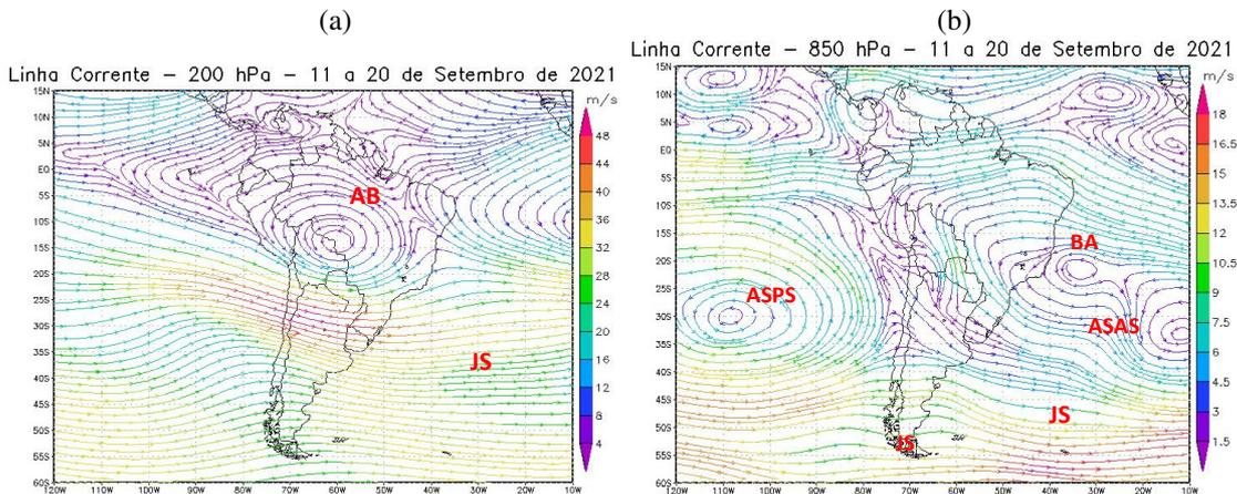
Figura 7 - Campos de Linha de Corrente 200 hPa. - (a) e 850 hPa. - (b), do 2º Decêndio de setembro de 2021; demonstrando interação entre os sistemas atmosféricos: Alta da Bolívia (AB), Jato Subtropical (JS), Bloqueio Atmosférico (BA), Anticiclone Subtropical do Atlântico Sul (ASAS) e o Anticiclone Subtropical do Pacífico Sul (ASPS).
