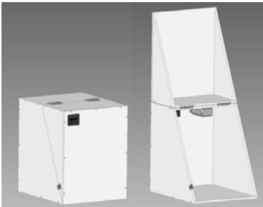
Figura 2. Desenho esquemático tridimensional da estufa para microscópios ópticos
