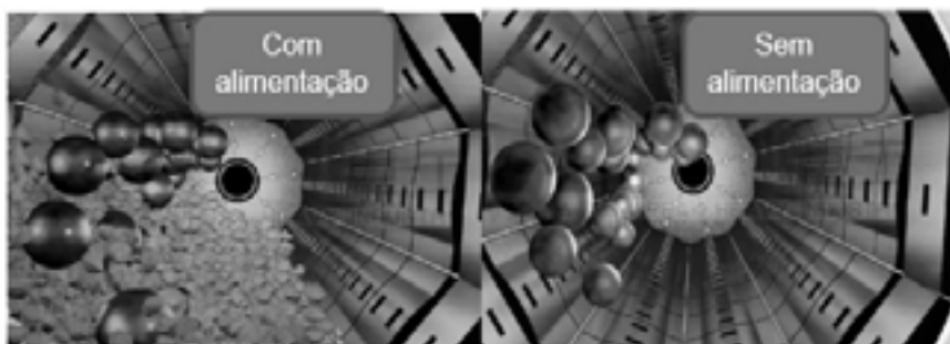
Figura 15. Desenho esquemático, moinho com alimentação e sem alimentação
