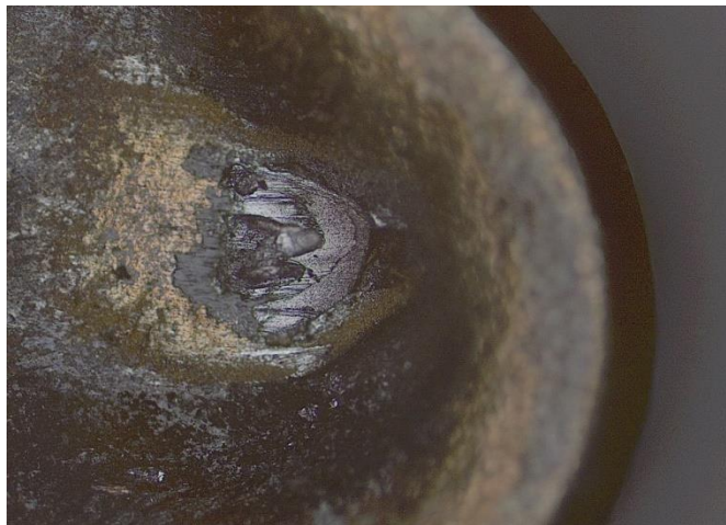
Figura 16: análise morfológica da superfície de saída 1º lote, aumento 10x
