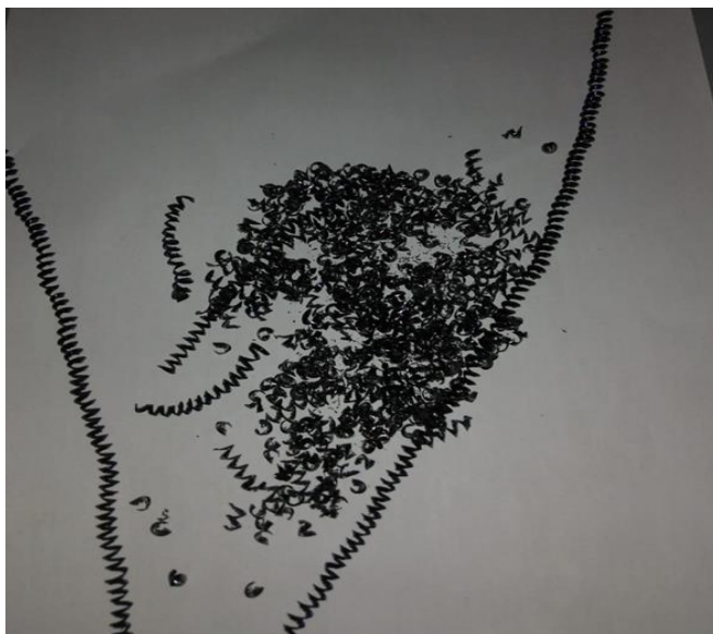
Figura 26: cavaco de corte 2º lote
