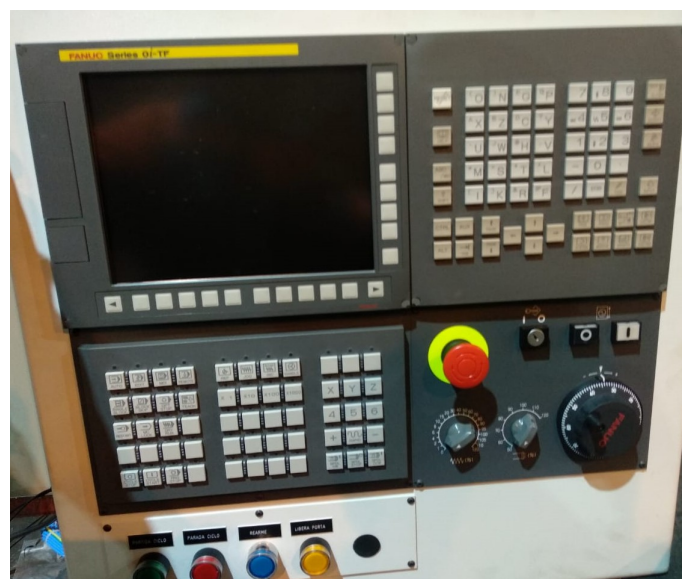
Figura 13 – Painel de Operação. Fonte: Arquivo próprio.
