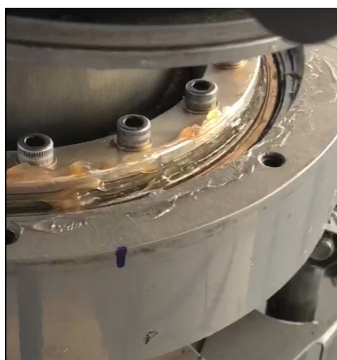
Figura 14 – Local de lubrificação do rolamento
